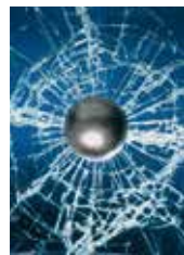
Test à Bille Norme EN 356 Ball-drop test EN 356 standard
