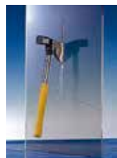
Test à la hache Norme EN 356 Axe test EN 356 standard
